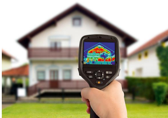
نمونه ای از دوربین حرارتی با کارکرد سنجش دما از راه دور بوسیله تصویر
